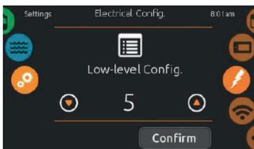
Um die Konfiguration, die Anzahl der Phasen und den Eingangsstrom des Badesystems zu ändern, schieben Sie das rechte Rad, bis das Symbol für die elektrischen Einstellungen in der Mitte hervorgehoben ist.
