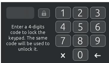
Wenn der Benutzer beabsichtigt, die Sperre zu verwenden, wird er zur Eingabe eines 4-stelligen Codes vom System aufgefordert. Derselbe Code wird zum Entsperren der Tastatur benötigt.
