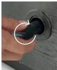
6. Um die Drainage zu stoppen, drehen Sie die Kappe im Uhrzeigersinn
