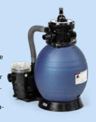
Im Paket enthalten sind ein Sockel, eine 250 W Pumpe, ein 4-Wege-Ventil, ein Verbindungsschlauch mit Schlauchklemmen, ein Filterbehälter sowie 500 g Kirami-Filterfasern. Um das Filtersystem mit dem Becken zu verbinden, benötigen Sie das passende Durchführungs-/ Schlauchset, das je nach Badefassmodell extra gekauft werden
